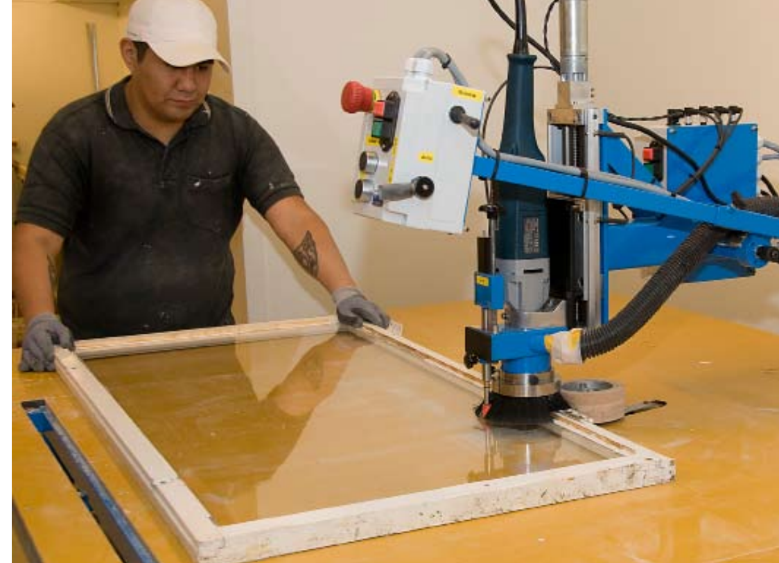
DEN HÄR NYA MASKINEN ÄR FÖNSTERVERKSTADENS NYA STOLHET. "KITTOFF" TAR BORT FÖNSTERKITT EFFEKTIVT UTAN ATT KROSSA GLASET.
